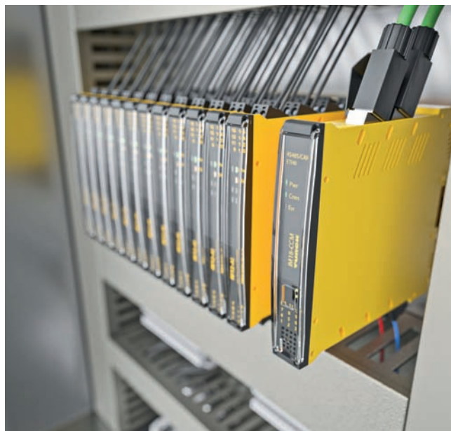
„Ochrana“ rozvádzača Turck IM18-CCM prenáša namerané hodnoty cez ethernet do IT sietí a môže ich dokonca vzdialene poselať.
